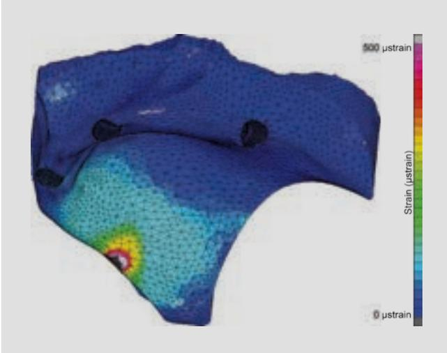
Abbildung 2: Belastung im Knochen bei der Brücke aus Pekkton® ivory mit einer Belastung von 400 N auf einem posterioren Implantat.
