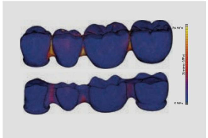
Abbildung 3: Belastungen in der verblendeten Brücke aus Pekkton® ivory bei einer Belastung von 100N.
