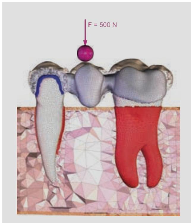
Abbildung 1: FE-Modell der dreiteiligen Brücke.
